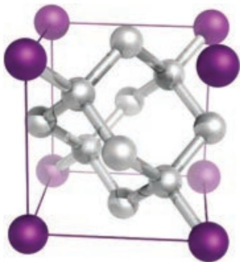
*Рис. 2. Кристаллическая структура алмаза представляет собой гранецентрированную кубическую решетку, в которую включено четыре дополнительных атома углерода. Каждый атом окружен четырьмя соседями, которые образуют правильный тетраэдр*
