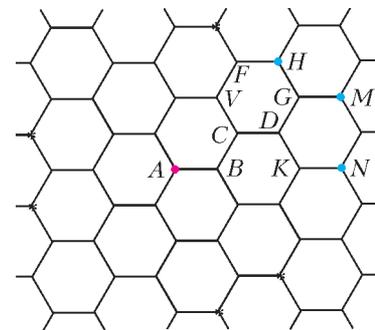
Согласно условию задачи, отношение токов, разбегающихся от узла  $C$ , в мостиках  $CV$  и  $CD$  равно  $k$ . В мостике  $CV$  течет ток  $I_{CV} = k\varepsilon/(6R)$ , где  $\varepsilon$  – напряжение батарейки, а в мостике  $CD$  течет ток  $I_{CD} = (1-k)\varepsilon/(6R)$ . Тогда на участке  $VF$  течет ток  $2k\varepsilon/(6R)$ , а на участке  $FH$  течет ток такой же, как на участке  $CV$ , т.е.  $k\varepsilon/(6R)$ . Узлы, эквивалентные узлу  $H$ , отмечены на рисунке звездочками.
