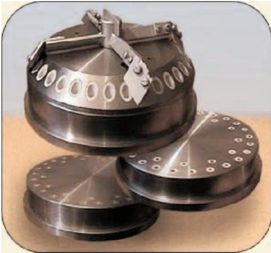
Рис.2. Фильтра (волока) для изготовления спагетти
