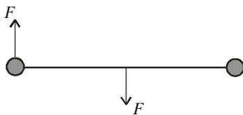
ких одинаковых шариков массой  $M$  каждый, закрепленных на концах стержня (см. рисунок). В некоторый момент на гантельку начинают действовать две горизонтальные противоположно направленные силы величины  $F$ , перпендикулярные стержню. Одна из них приложена к центру стержня, другая – к одному из шариков (силы все время остаются перпендикулярными к стержню и приложенными в упомянутых точках).
