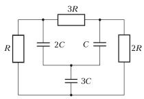
опускать слова «сопротивлением» и «емкостью») равна нулю (конденсаторы С и 3С не заряжены). Легко сообразить, что эта разность потенциалов так и останется нулевой. Действительно, от-
