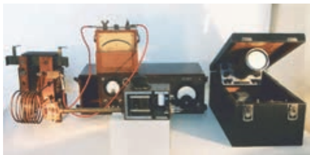
Рис. 6. Экспериментальная установка Е.К.Завойского, 1943–1944 годы
