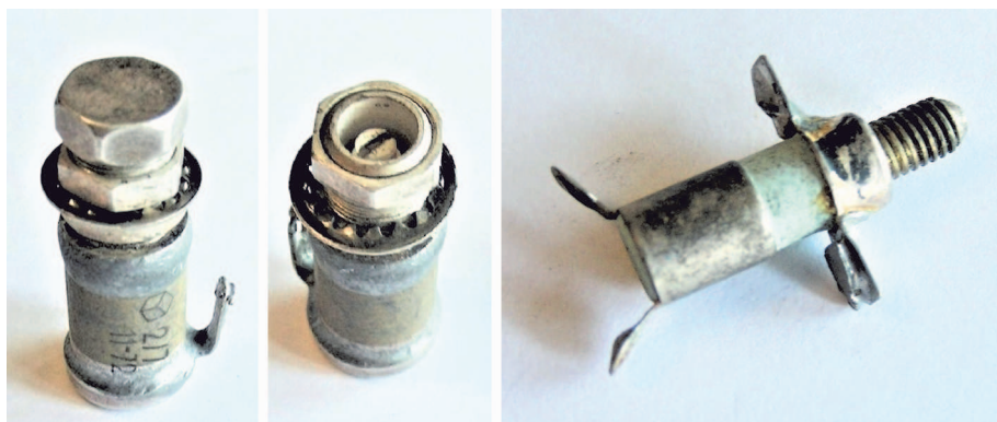
Рис. 7. Подстроечный цилиндрический конденсатор с винтом, две реализации
