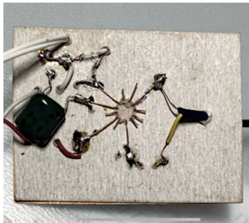
Рис. 4. Первый прототип платы на картонке
