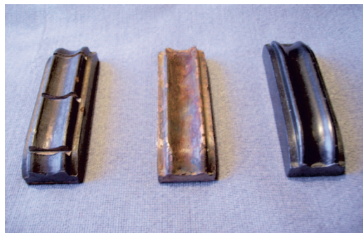
Рис. 7. Контакты троллейбуса: справа – углеродный, слева – чугунные. Прорези – для сцарапывания льда
