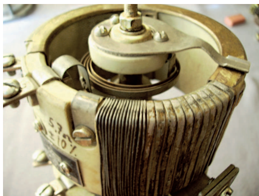
Рис. 3. Реостат с переменным сечением проволоки для расширения диапазона регулирования (середина прошлого века)
