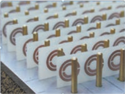
Рис. 5. Структура из метаматериала, включающая комбинации отрезков прямых проволочек и двойных разрезанных колец в диэлектрике
