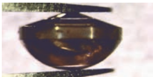
Рис. 9. Фотография алмазной наковальни со сферической короной, сделанная под микроскопом. Диаметр ее 2,5 мм
