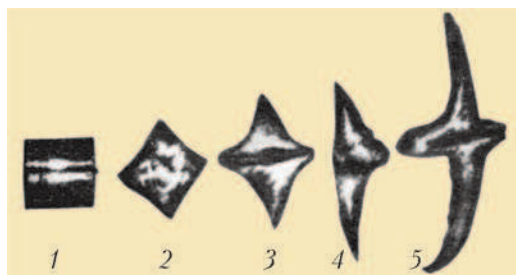
Влияние циклического нагрева, охватывающего два фазовых перехода 668 °С и 775 °С: 1 – исходный образец, 2 – после 50 циклов, 3 – 100 циклов, 4 – 187 циклов, 5 – 250 циклов
