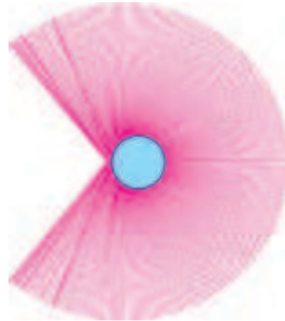
Рис. 14. Все лучи, выходящие из капли после двух внутренних отражений
