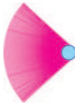
Рис. 9. Все лучи, выходящие из капли после одного внутреннего отражения
