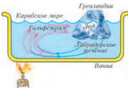
Рис.1. Иллюстрация простейшей кинематической модели циркуляции воды в мировом океане
