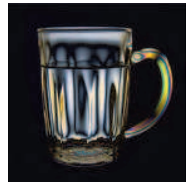
Рис.9. Иллюстрация явления фотоупругости
