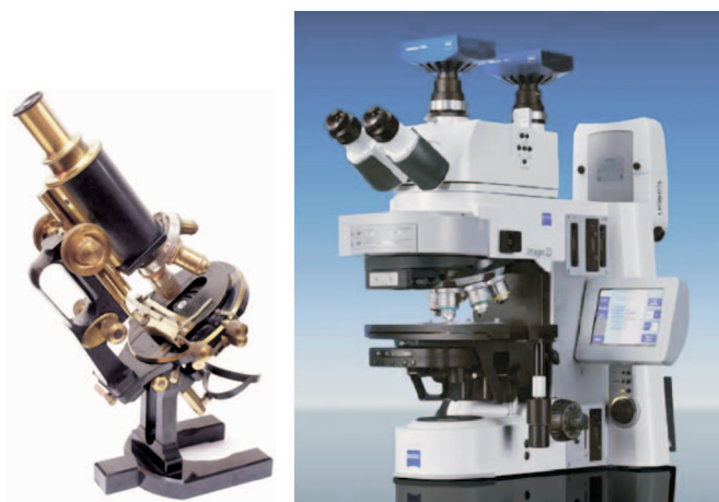
Рис.1. Оптические микроскопы. Слева – микроскоп фирмы Carl Zeiss 1906 года, справа – современный исследовательский микроскоп той же фирмы с двумя видеокамерами на основе ПЗС-матриц сверху
