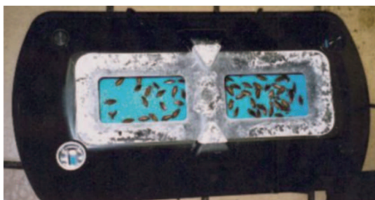
Рис. 8. Электростатическая ловушка для тараканов
