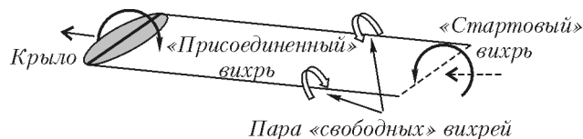
Рис.2. Вихревая схема крыла в первом приближении
