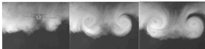
Рис.1. Вихревая пелена за крылом сворачивается в пару вихрей
